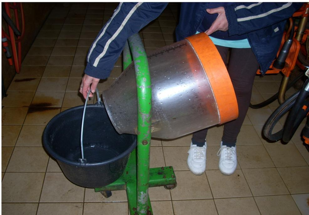
Bidon à lait adapté sur un socle à roulettes.
